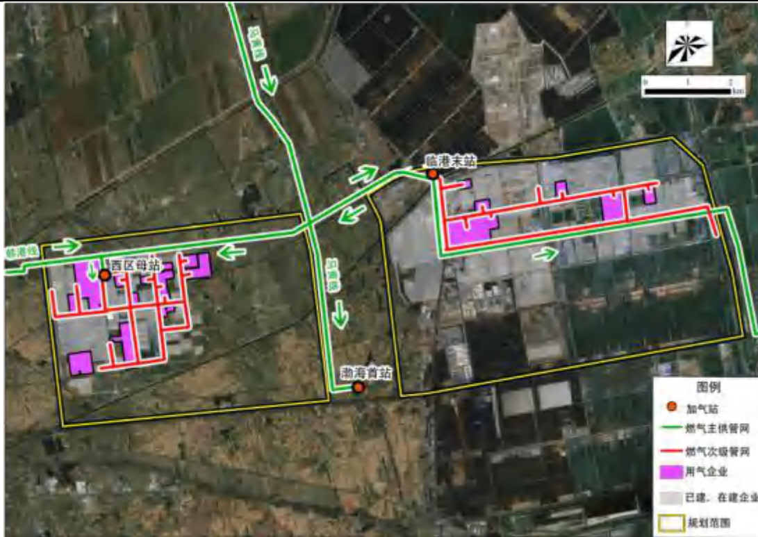
图 2.8.2-1 临港开发区供气管网图
